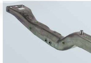
Podłużnica samochodowa wykonana metodą hydro-formowania
